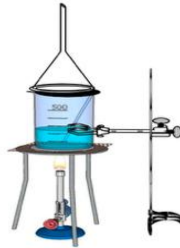
Şekil 3. Süblimleşme olayı ve naftalinin süblimleşmesine ait deney düzeneği
